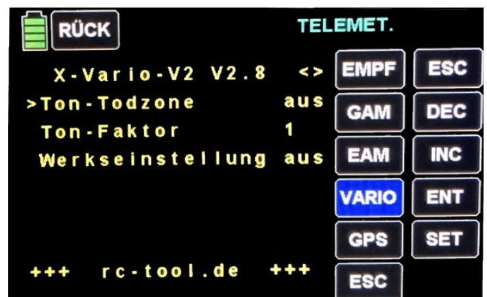
Abbildung 7: Einstellung für neue Graupner Sender ohne Ausblendung des Sinkbereiches
